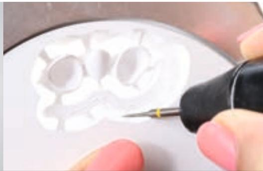
**07b & c** Für die Arbeitsschritte vor dem Sinterprozess und so auch für die Bearbeitung des kreidartigen Zirkonoxids gilt es insbesondere, abgestimmte Hartmetallfräser zu verwenden
