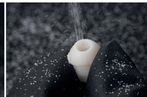
Abb. 7: Konditionieren der Innenfläche der Zirkonoxid-Hülse: Abstrahlen mit Aluminiumoxid 0,5-1 bar // 50 µm.
