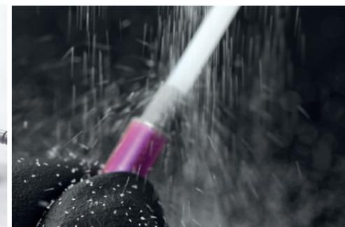
Abb. 6: Konditionieren der Titanbasis: Abstrahlen mit Aluminiumoxid 1-1,5 bar // 50-110 µm.
