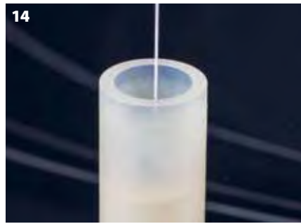
Abb. 14: Die Einbettmasse GC LiSi Press Vest zeichnet sich aus durch eine besonders gute Fließfähigkeit.
