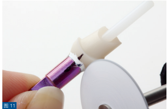
图 11: 固化后用橡胶抛光轮仔细地处理粘接间隙。
