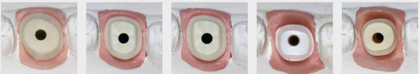
**Abb. 1 bis 4** Okklusale Ansicht von CAD/CAM-gefertigten Zirkonoxid-Abutment-Proben verschiedener Hersteller auf demselben Meistermodell. Einige wiesen mechanische Oberflächendefekte und Unregelmäßigkeiten an der Abutment-Schulter auf.
