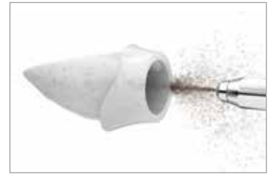
22b Klebeflächen (hier Kappchen-Innenfläche) und die Klebeschulter werden mit Aluminiumoxid abgestrahlt
