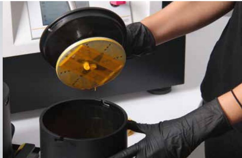
**03 & 04** Ein Beispiel für CAD/Cast-Gerüste. Zwei Veneers werden in der 3Shape-Software 2015 virtuell konstruiert und mittels 3D-Druck aus einem ausbrennfähigen Spezialharz gefertigt. Das rechte Bild zeigt die Entnahme der gedruckten Objekte aus der Kartusche
