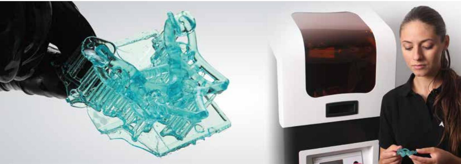
**21 & 22** Die Bohrschablone wird unmittelbar nach dem 3D-Druck dem Varseo entnommen und danach vom Stempel gelöst
