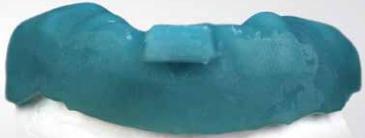
**01 & 02** Beispiele für den 3D-Druck mit dem Varseo von Bego: Ungesägtes Kontrollmodell und individueller Abformlöffel. Solche Indikationen können sehr präzise und in sehr guter Qualität hergestellt werden. Die veränderte Fertigungstechnologie hat hier Vorteile gegenüber den subtraktiven Fertigungsverfahren
