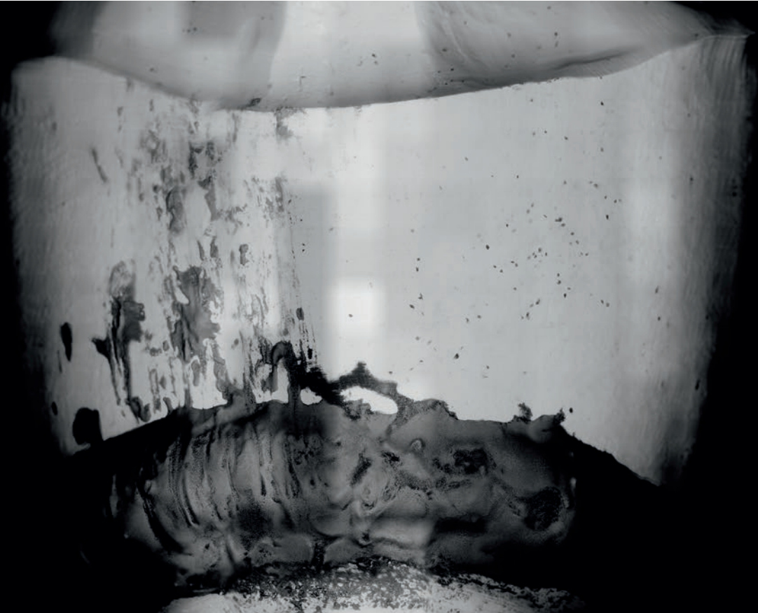
02 REM-Aufnahme des submukösen Bereichs eines Hybridabutments. Verunreinigungen auf der Oberfläche sind erkennbar. Die Aufnahme stellt zudem die starken Verunreinigungen nach dem Verkleben (Klebrückstände) dar, die durch ein unsachgemäßes Klebeprotokoll (ohne Polier- & Reinigung) auftreten können (REM: D. Duddeck, mmmri.berlin)
