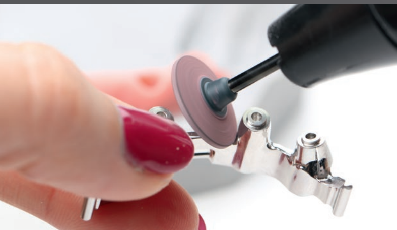
09 & 10 Nicht nur die Abutments sondern auch die basalen Anteile von Stegen können mit dem Panther Abutment Surface Kit optimal bearbeitet werden
