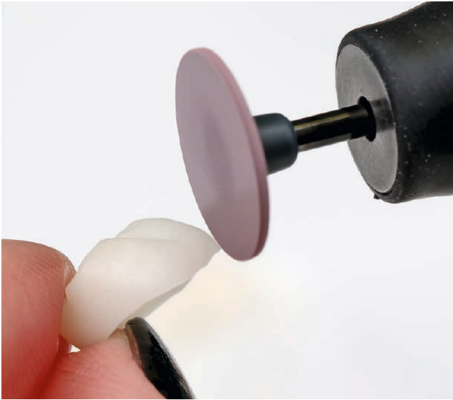
►7 Die Linse 150 smooth lila ist eine neue Mischform. Sie ist eine Kombination aus Rad und Linse.
