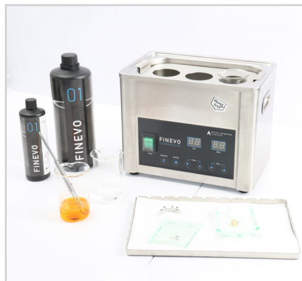
Abb. 10 und 11: Standardisiertes dreistufiges Reinigungsverfahren mit einem Waschprotokoll im Ultraschallbad.
