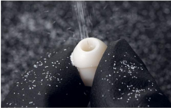
**Abb. 14** Abstrahlen der Innenfläche der Abutmentkappe aus Zirkonoxid mit 50 µm bei 0,5 bis 1 bar.
