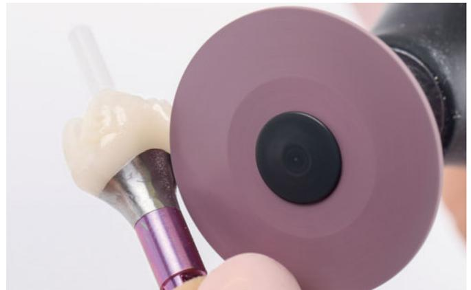
**Abb. 22** Erarbeiten der geforderten Oberflächentopografie (RA-Wert 0,21-0,40  $\mu\text{m}$ ) im submukösen Bereich mit entsprechendem Polierer (Panther edition Lense 260 smooth, Sirius Ceramics).
