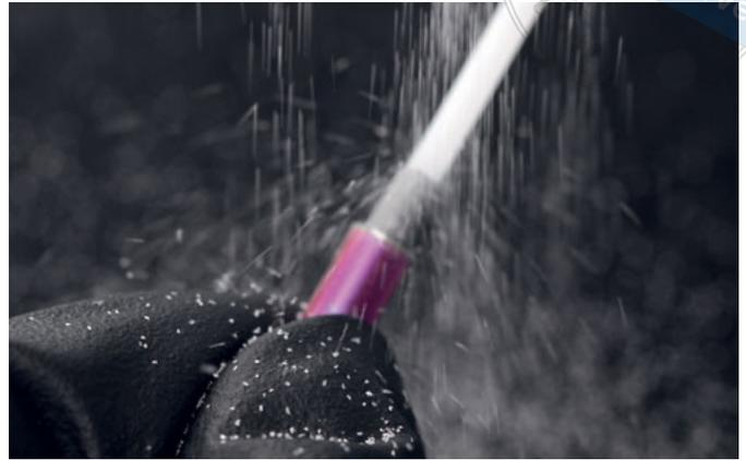
**Abb. 15** Abstrahlen der Titanklebebasis mit Aluminiumoxid bei 110 µm und 1,5 bar.
