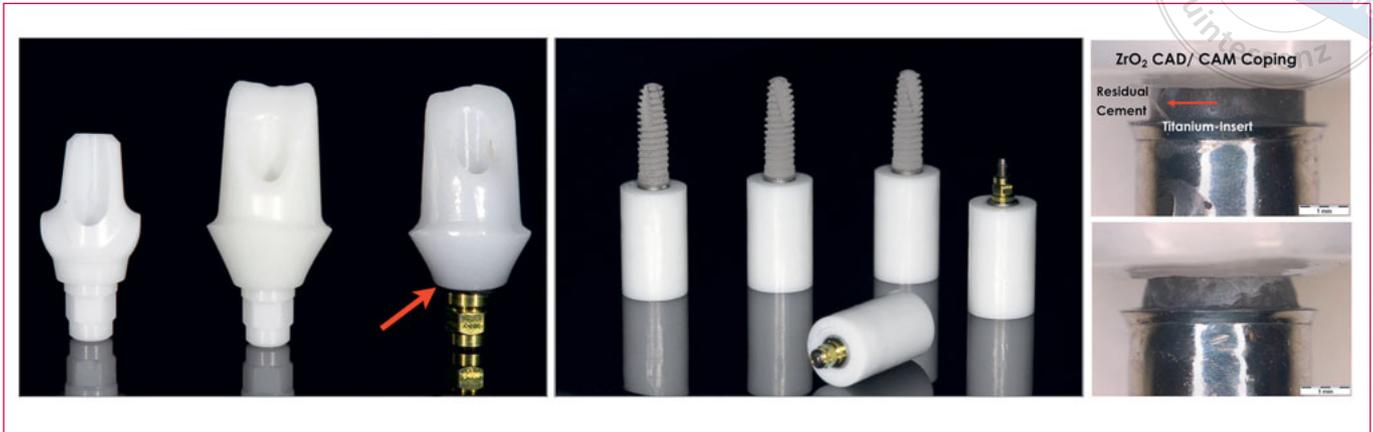
**Abb. 2 und 3** Die Abbildungen resultieren aus einer Studie zur Verklebung zweiteiliger CAD/CAM-Hybridabutments.<sup>4</sup> Die mittlere Klebekraft von allen untersuchten Resin-Zementen überschritt die Bruchgrenzwerte von 380-430 N für Zirkonoxidabutments mit internen Verbindungen. Es kommt also eher zum Bruch der Zirkonoxidhülse, bevor ein Retentionsverlust auftritt.
