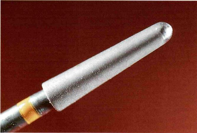
Abb. 12 Ist der Schleifer beschädigt, muss er ausgewechselt werden. Eindruck der Schleiferoberfläche nach etwa fünfzehn Schleifzyklen.
