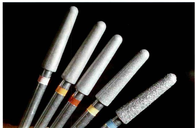
Abb. 11 Fünf verschiedene Körnungen sorgen bei der Bearbeitung für einen maximalen Oberflächenglanz des Primärteiles.
