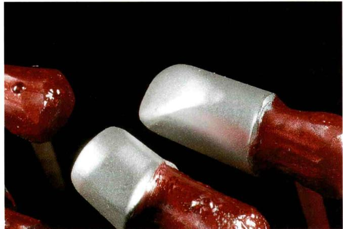
Abb. 31 Durch Abdeckung überschüssiger Silberanteile mit Speziallack wird eine Abscheidung in überflüssigen Bereichen vermieden.
