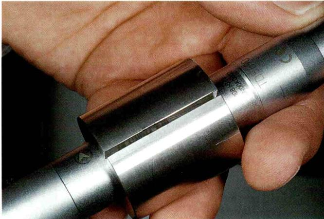
Abb. 15 Zur individuellen Adaption der Turbine an jedes herkömmliche Fräsgerät muss ein Präzisionssprengring angeliefert und nach den Gerätedaten abgestimmt werden.
