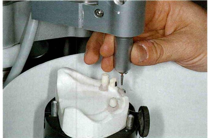
Abb. 16 Vorbereitetes Fräsgerät mit Turbine zur Bearbeitung der Vollkeramik unter Wasserkühlung.
