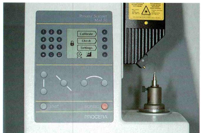
Abb. 6a und 6b Mit dem Procera-Scanner werden mittels doppeltem Scan die Daten errechnet und zur Fertigung nach Stockholm versandt. Das Wachskäppchen wurde zuvor konisch gefräst.
